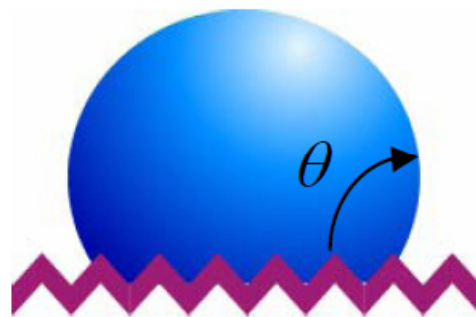
圖-3液體於符合Wenzel's Theory 的表面示意圖
