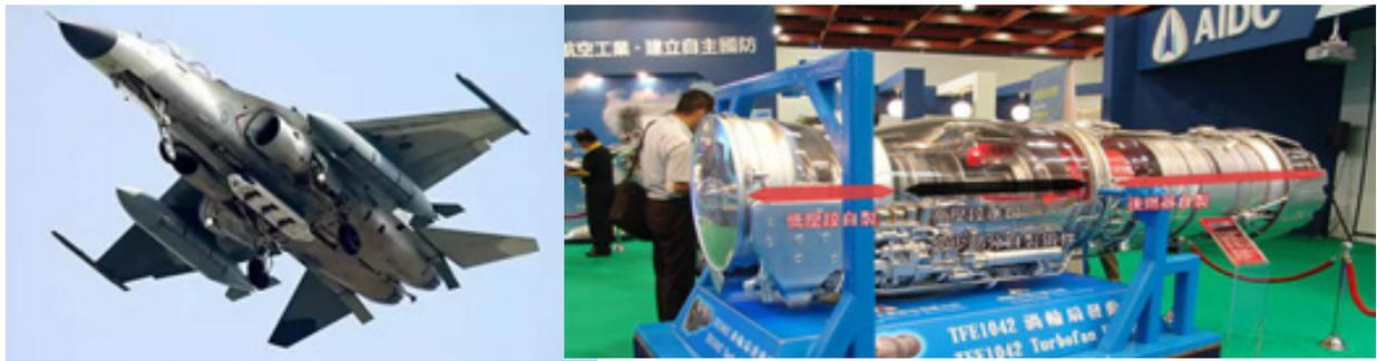
圖 10、國造 IDF 戰機及其 TFE-1042 型渦輪扇噴射發動機
