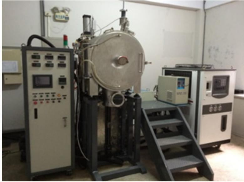
圖 8、機動系精密鎢鑄實驗室真空感應熔解單晶鑄造爐
