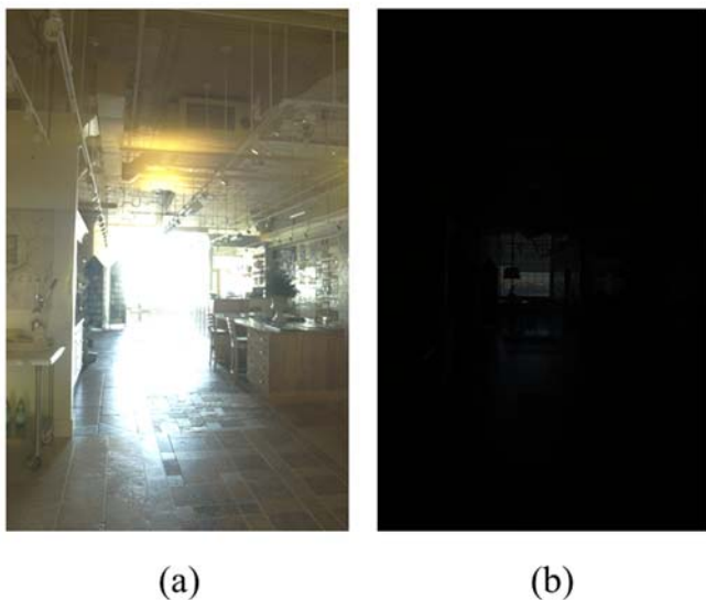
圖 1、曝光度不同所顯示的影像 (a)14 stops; (b) 0 stops
