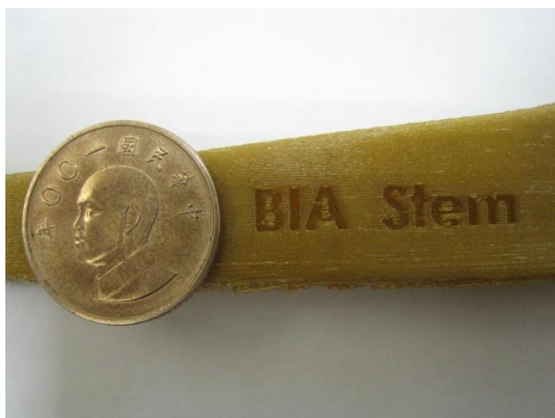
圖四、自行設計產出之積層製造人工關節 (使用 FDM 技術)
