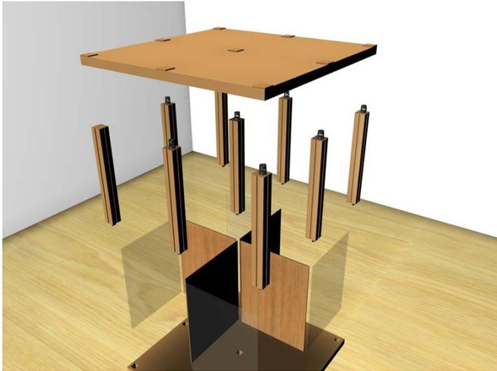
圖 2 扣件接頭零件結合桿體
