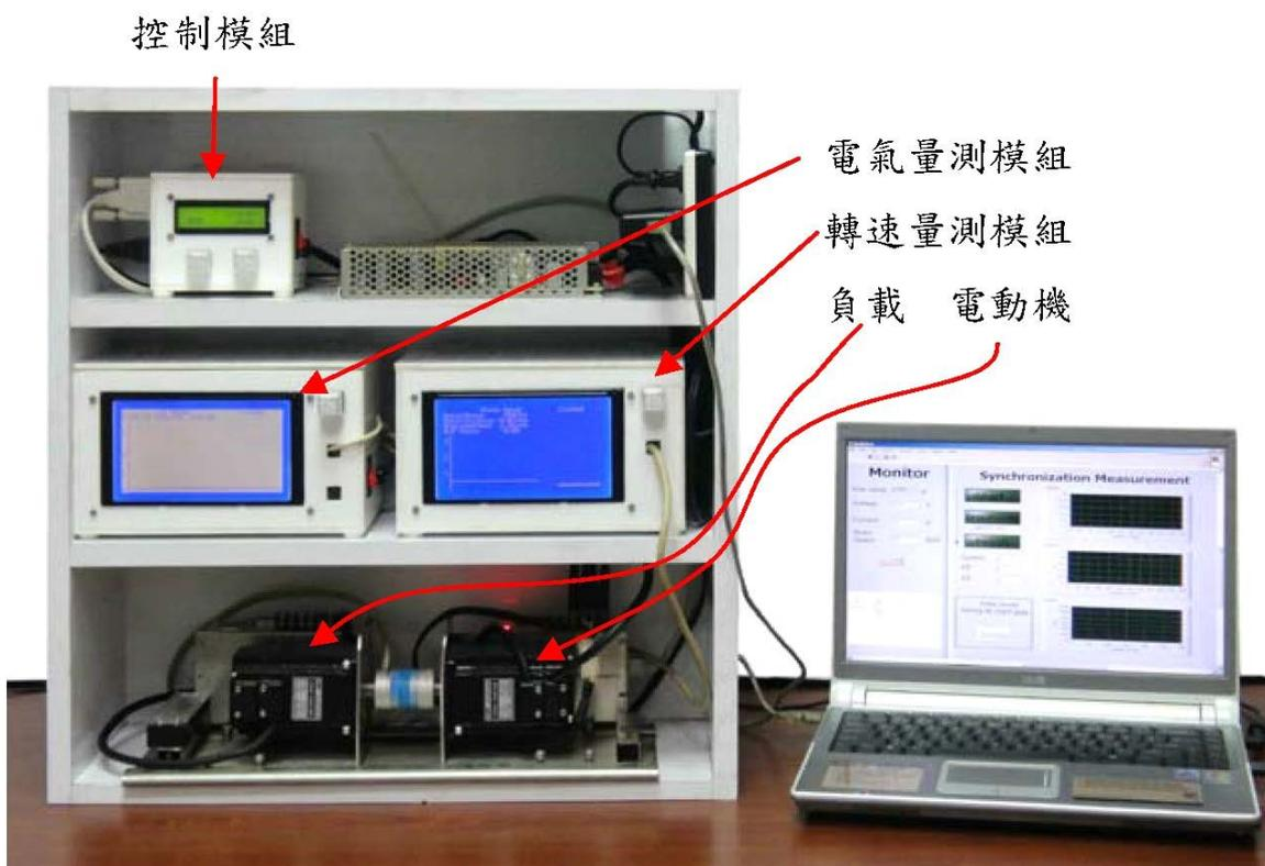
圖 7 同步量測系統實體
